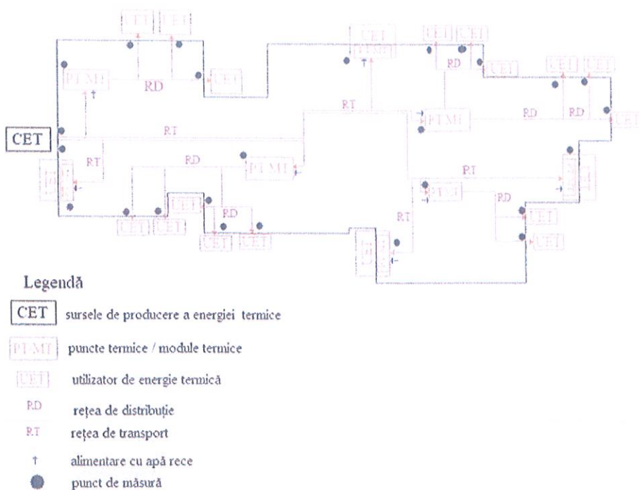
Figura 9.1 – Schema fluxului tehnologic al S SACET Râmnicu Vâlcea cu puncte de măsură
